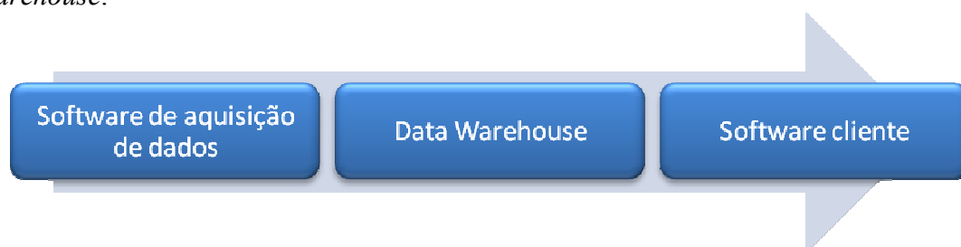
Figura 5 - Arquitetura de um data warehouse
