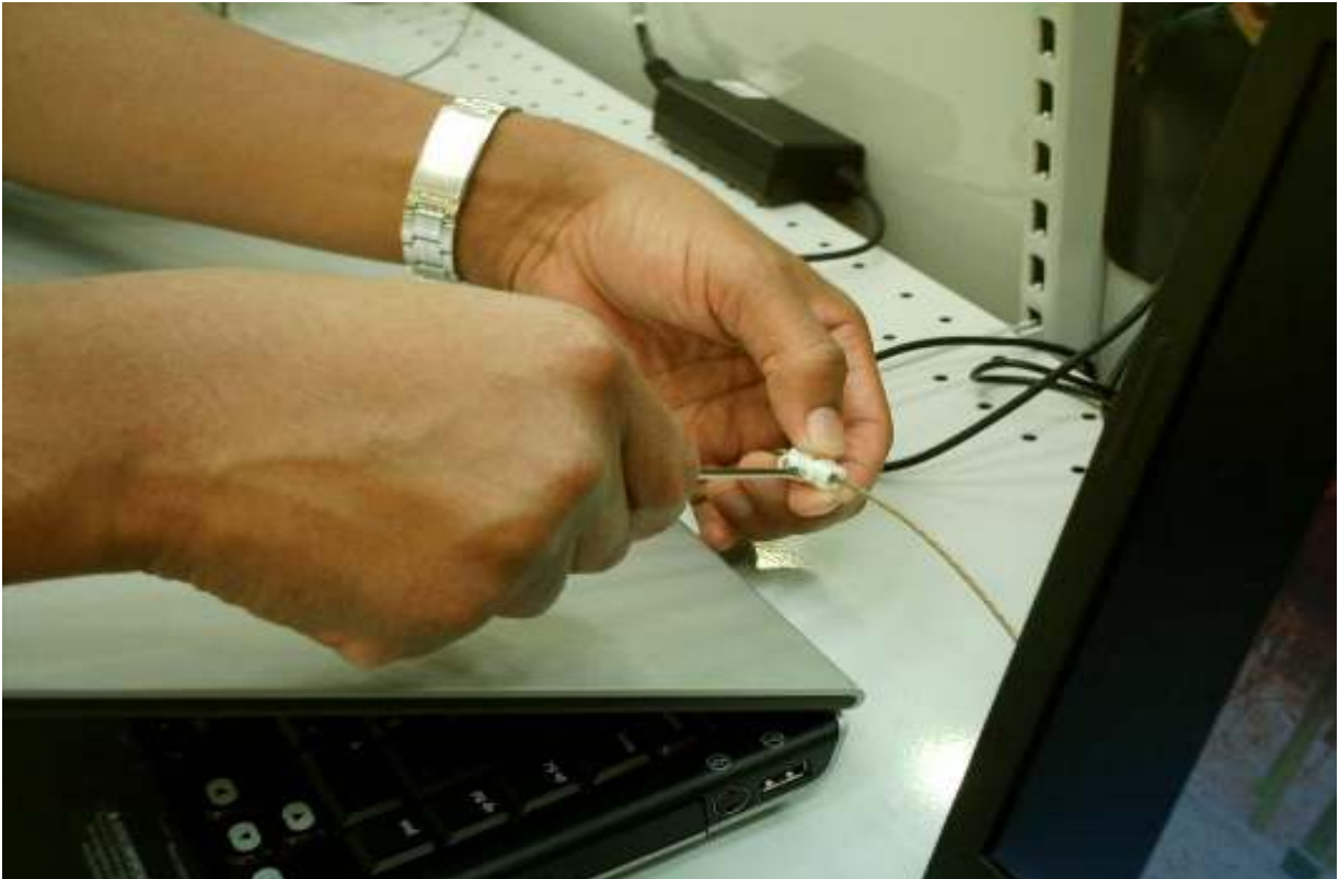
Figura 28 - Exemplo de montagem do cabo de aço em conector para proteção de notebook.
